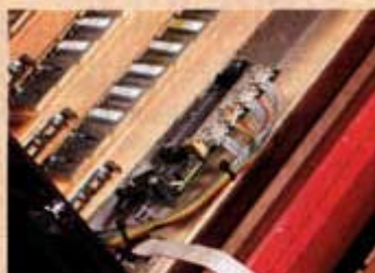
Zentraleinheit (CPU-Platine) mit abgehendem 10-Pol-Balgekabel mit DIN-Stecker.
