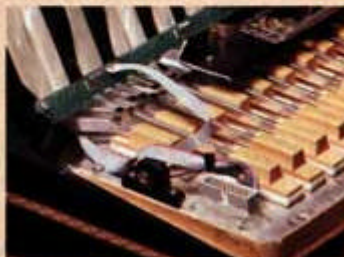
Vorne: MIDI-out und Controller. Dahinter: Tasten mit Magneten und Hallsensoren.
