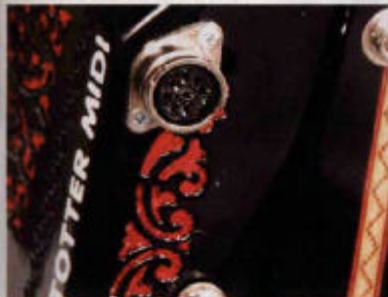
Schnittstelle: die 8-polige MIDI-Buchse.
