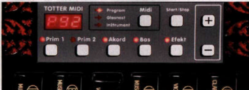
Eine dreistellige LED und Leuchtdioden informieren über den aktuellen Betriebszustand.
